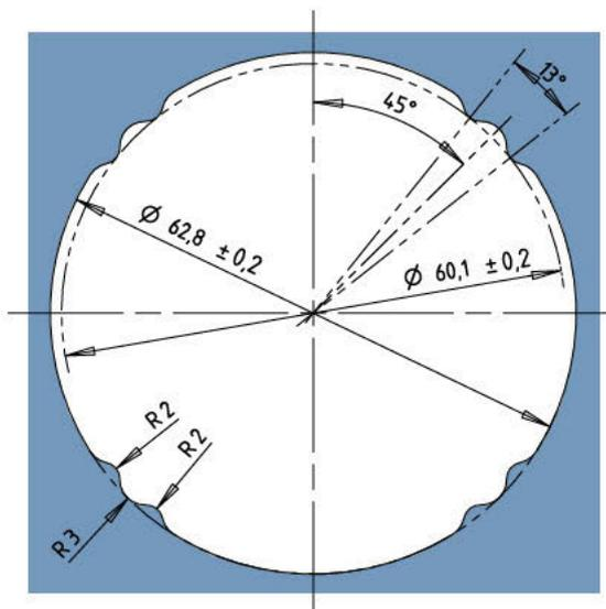
2. Vertiefter Einbau in Holztüren mittels Sonderfräsung und optionaler Einbauschaale
